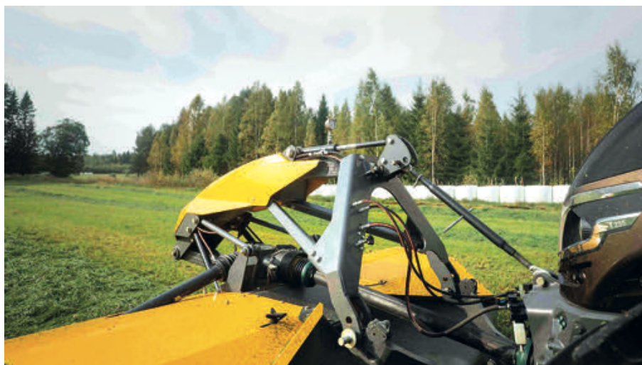
Foto 7. Cabezal Elho de segadora frontal con sistema HydroBalance.
