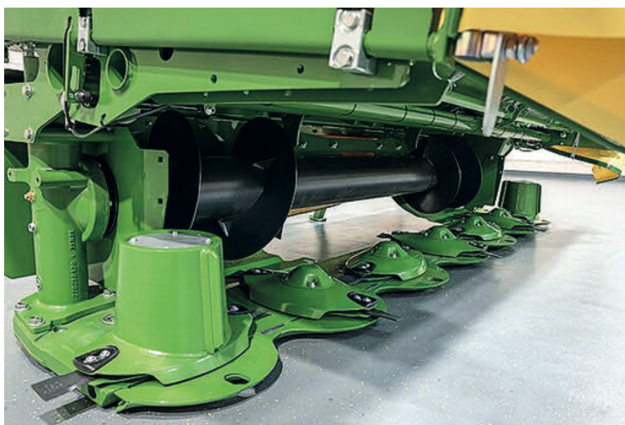
Foto 3. Tornillo sinfín en segadoras Krone Easy Cut F320 y 360 que se puede montar como opción.
