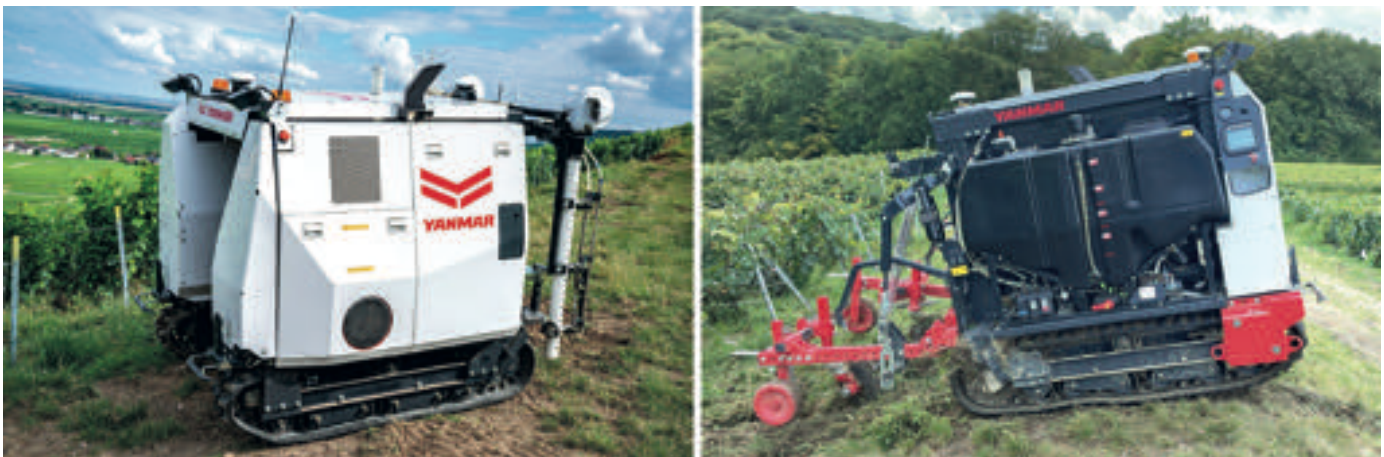
Foto 6. Equipo compacto cabalgante de Yanmar. En la foto de la derecha, en configuración para desherbaje mecánico.
