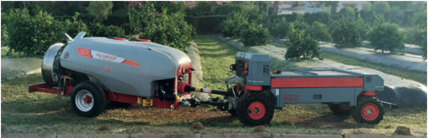
Foto 5. Equipo Mula 1250 U4 arrastrando un atomizador convencional.
