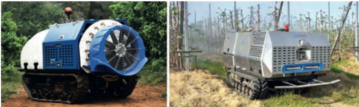
Foto 3. Robots atomizadores compactos de LJ Tech. En la foto de la izquierda, el modelo S500, y en la de la derecha, el modelo S1000.
