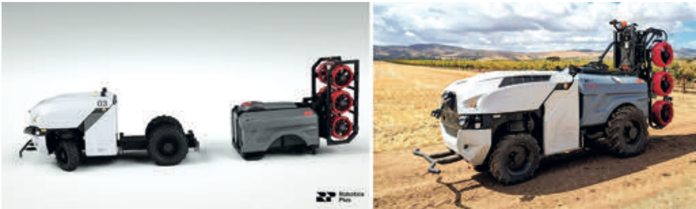
Foto 9. Sistema modular de Prospr y equipo de aplicación con ventiladores independientes Croplands Quantum.
