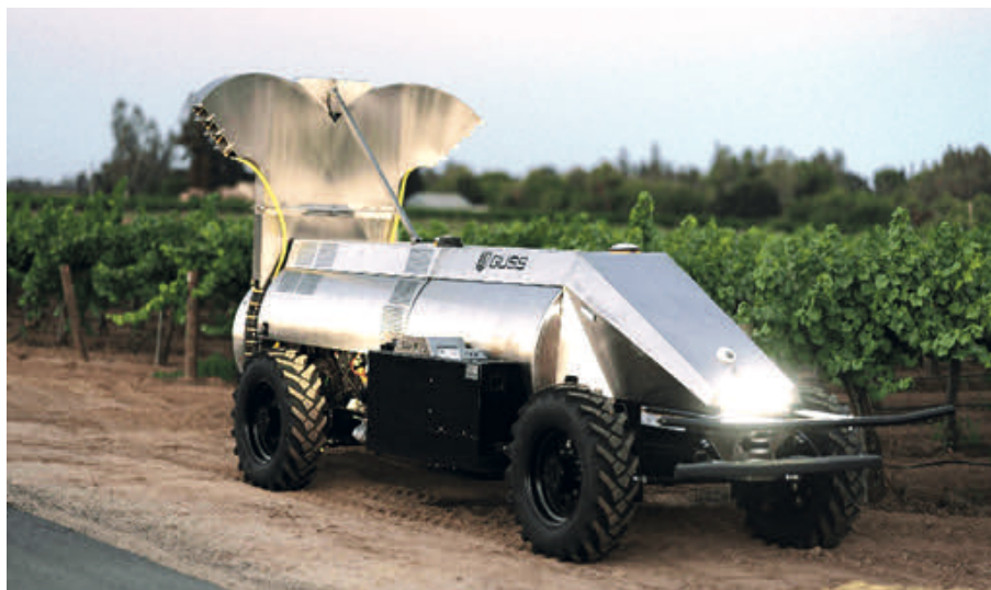
Foto 7. Equipo Guss con unidad de aire de tipo axial y secciones separadas.
