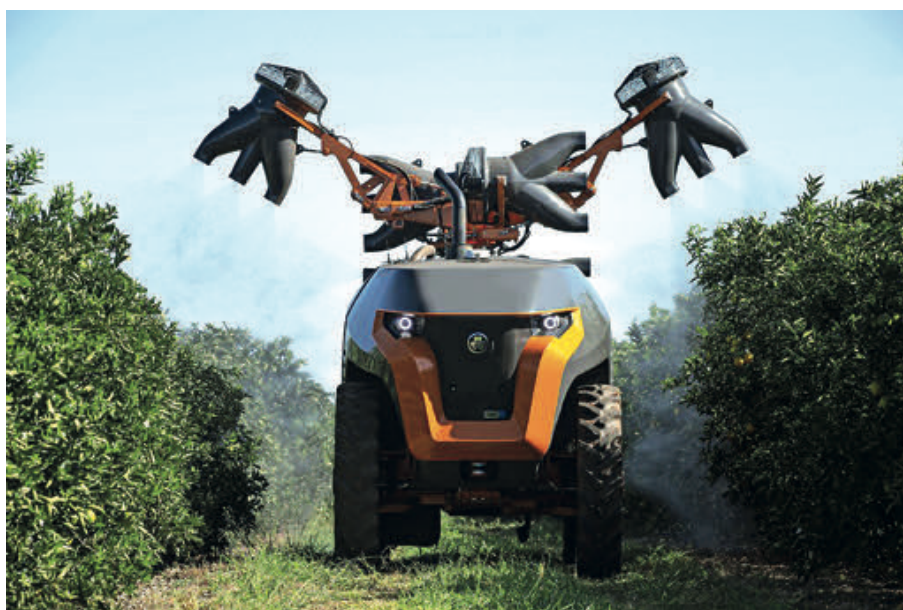
Foto 8. Jacto Arbus en acción, en el que se aprecian los ventiladores independientes orientables con salida de aire con tres boquillas cada uno.
