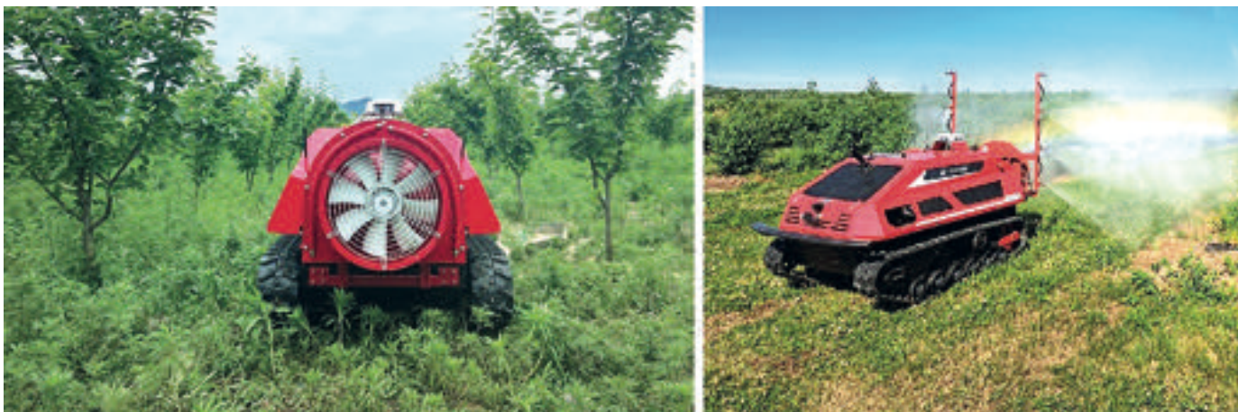
Foto 4. Robot Ally Nav mostrando distintas opciones de pulverización.
