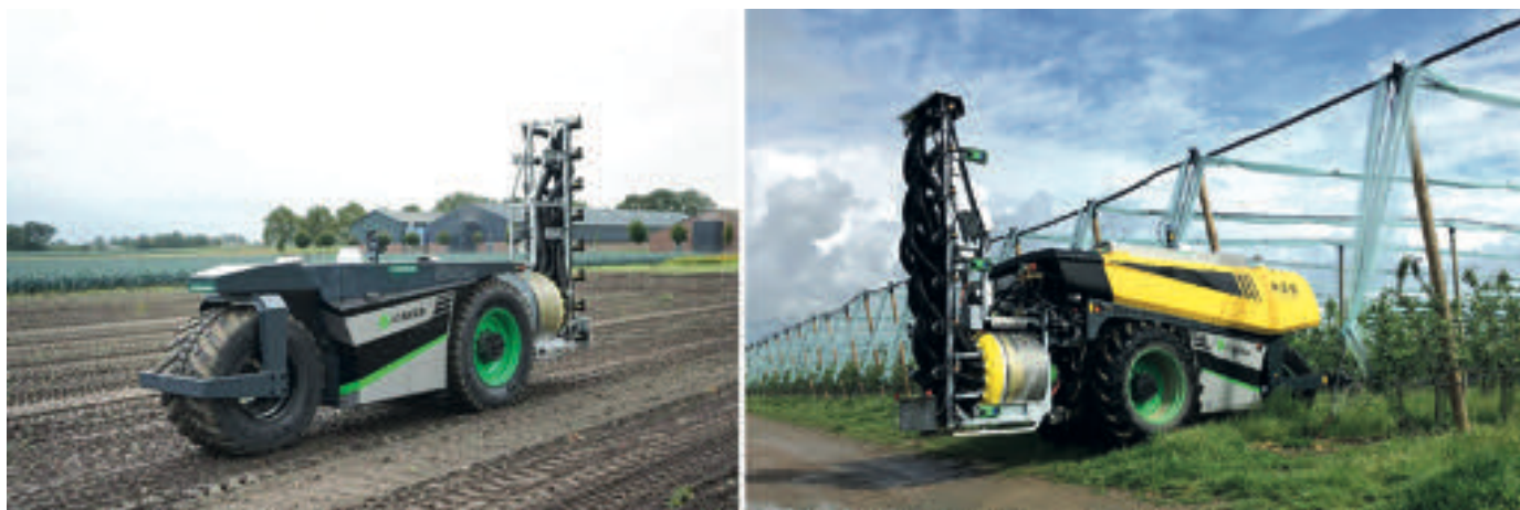
Foto 2. HSS sobre Agbot de AgXeed. A la izquierda, sin depósito. A la derecha pueden apreciarse en color verde las cámaras de detección de vegetación de Rometron.
