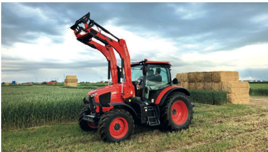
Kubota M6-132. Todos montan un motor Turboalimentado Intercooler Kubota V 6108-TIER5 de 4 cilindros y 6.124 cm<sup>3</sup> de cilindrada.
