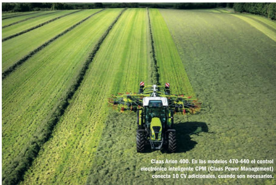
Claas Arion 400. En los modelos 470-440 el control electrónico inteligente CPM (Claas Power Management) conecta 10 CV adicionales, cuando son necesarios.
