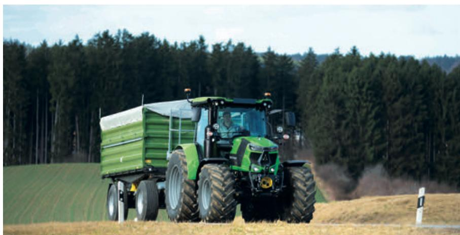
**Deutz Fahr 6C Series.** Los motores están disponibles en una gama de potencias máxima de 120, 129 y 137 CV (modelos 6115C, 6125C y 6135C, respectivamente).
