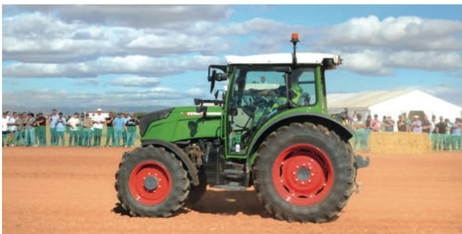
Fendt Serie 3. Sistema TMS de gestión del tractor, coordinando la carga del motor y la velocidad de desplazamiento.
