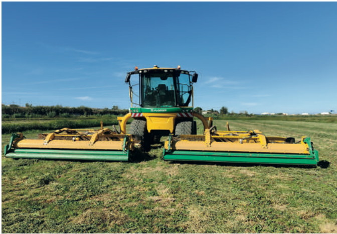
Foto 10. Equipo trabajando con los dos cabezales separados y las cintas hileradoras girando en sentidos inversos, conformando el cordón en el centro de la máquina.
