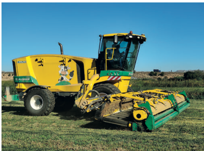
Foto 8. Equipo trabajando con los dos cabezales juntos y las cintas hileradoras girando en el mismo sentido, conformando el cordón en un lateral de la máquina.
