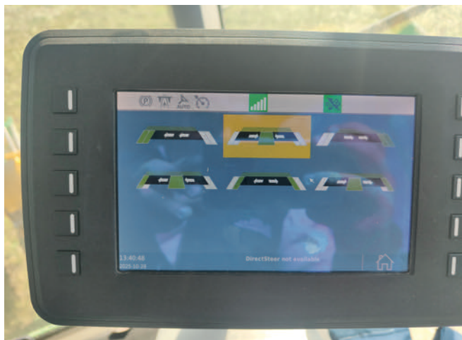
Foto 7. Pantalla de cabina con las seis opciones de configuración de sentido de giro de las cintas y separación entre cintas.
