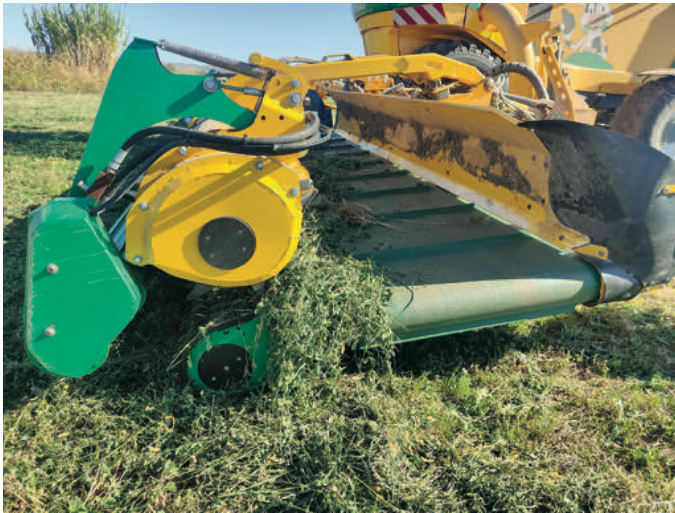
Foto 2. Cabezal de recogida/hilerado con pick-up inferior y cinta hileradora trasera.
