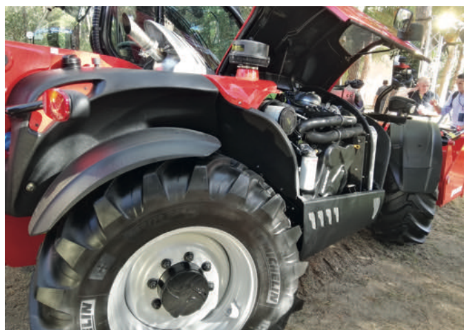
Foto 5. Neumático Michelin 460/70 R 24 IND con marcaje IND (industrial) montado en cargadora telescópica Manitou.
