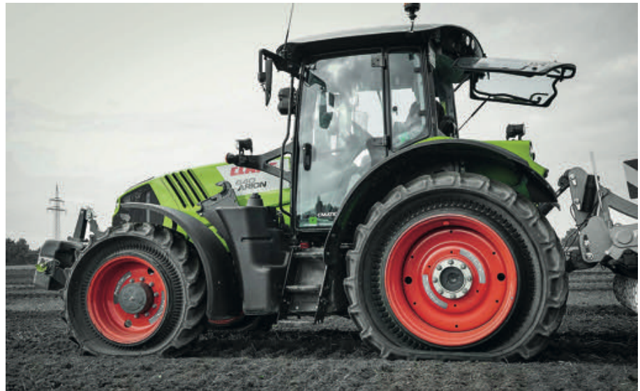
Foto 6. Tractor Claas Arion 640 equipado con neumáticos con tecnología Cup Wheel. Fuente Irish Farmers Journal.
