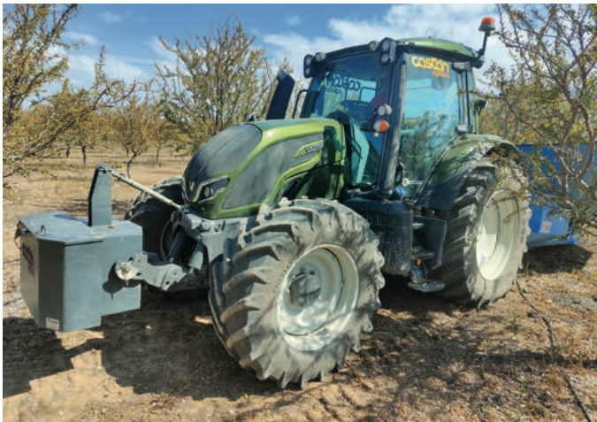
Foto 2. Tractor Valtra Twin Trac N 155 equipado con neumáticos delanteros Trelleborg TM800 (480/65R28 135D) y traseros Trelleborg TM800 (600/65R38 153D).
