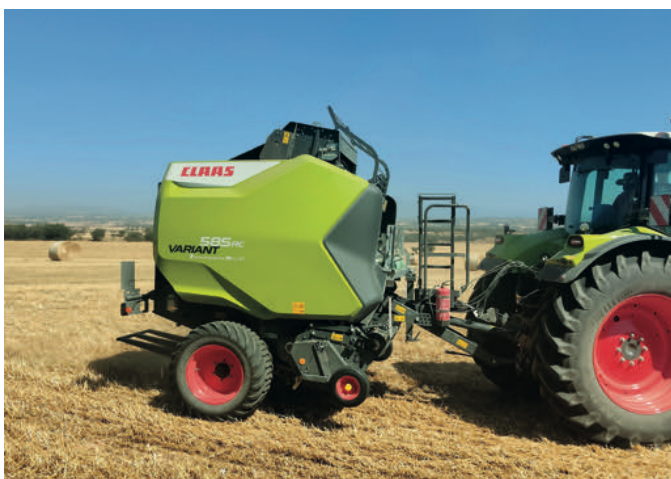
Foto 4. Neumático Trelleborg Twin 404 con marcaje IMP (implement) montado en rotoempacadora Claas Variant 585 RC.
