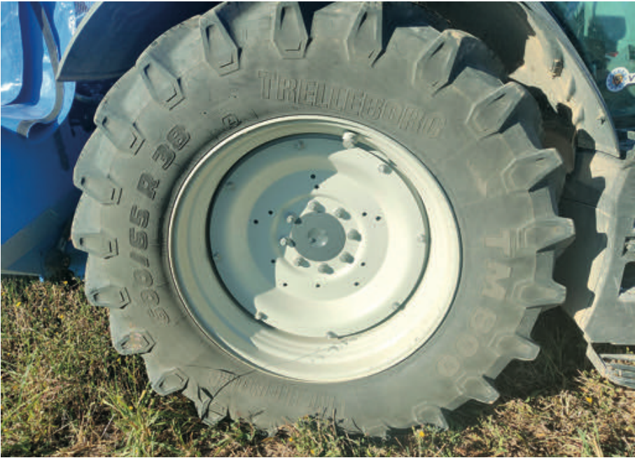
Foto 3. Neumático Trelleborg 600/65R38, modelo TM800, con nomenclatura según norma ETRTO. VF 520/85 R
