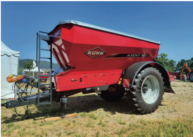
Foto 1. Neumático Mitas VF 520/85 R 42 CFO, modelo HC 300, equipado con tecnología de flexión VF-CFO en una abonadora arrastrada Kuhn Axent 90.1.
