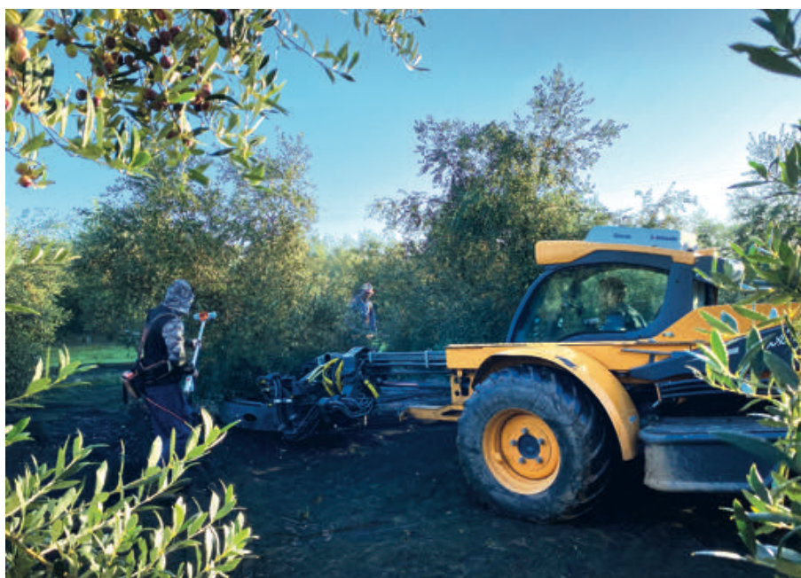
Foto 5. Recolección con vibrador de tronco con apoyo al derribo en el tratamiento I.
