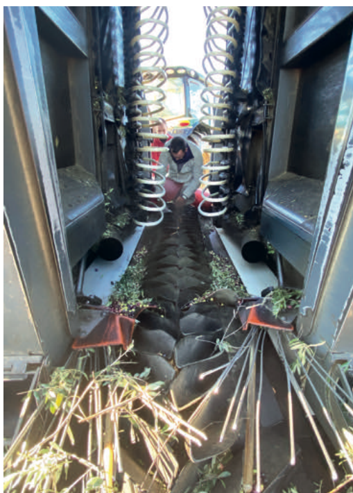
Foto 8. Tras la recolección de cada fila se procedía a la limpieza interior de la cosechadora.
