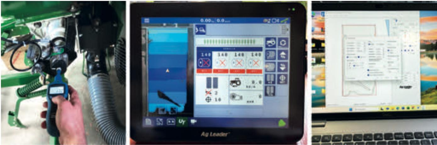
Foto 2. Izquierda: detalle de la medida del régimen del dosificador con tacómetro digital. Centro: pantalla UT de trabajo de la sembradora y mapa de prescripción para la medida de regímenes a distintas dosis. Derecha: pantalla de trabajo del simulador de posicionamiento y velocidad de tractor.
