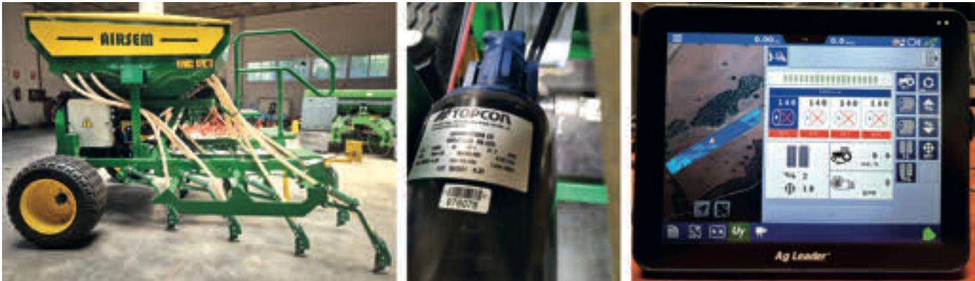
Foto 1. Sembradora neumática a chorrillo GIL modelo Airsem-L-4F, motor eléctrico de accionamiento del dosificador y pantalla InCommand 1200 de Ag Leader.
