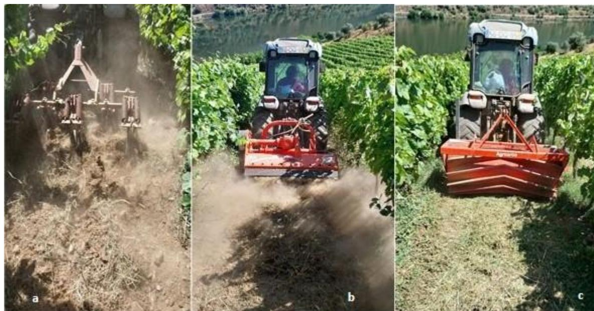
Figura 5. a) LABOREO: suelo labrado, b) SIEGA: vegetación segada, c) RODADURA: vegetación aplastada<sup>23</sup>
