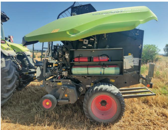
Foto 2. Zona interior del lateral izquierdo con extintores y malla de recambio.
