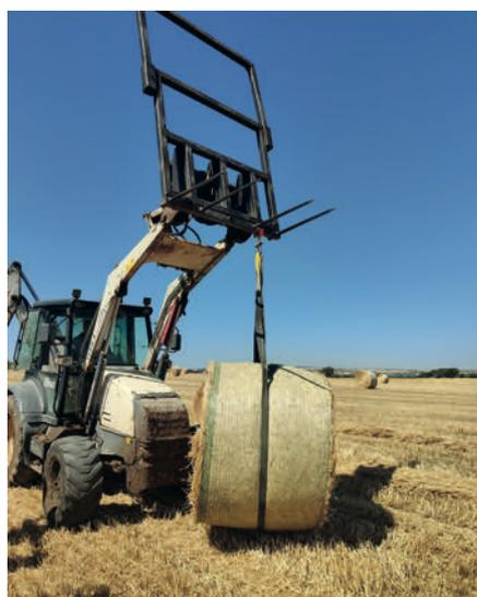
Foto 8. Pesaje de paca en campo con báscula colgante acoplada a elevador frontal.
