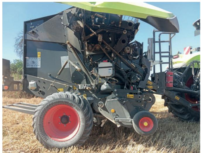
Foto 3. Interior lateral derecho con depósito de lubricación y cadenas de transmisión.
