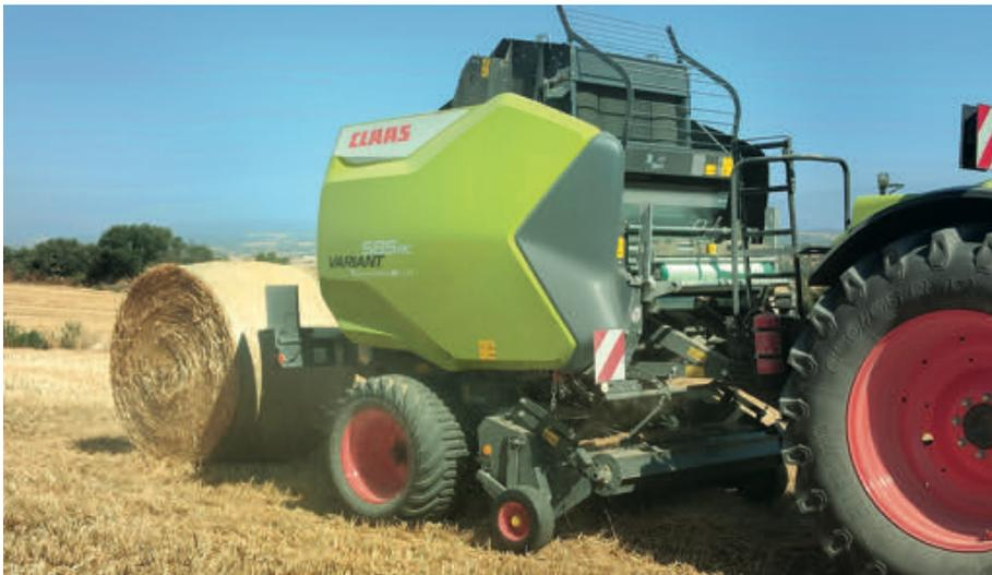
Foto 1. Rotoempacadora de cámara variable Claas Variant 585 RC.
