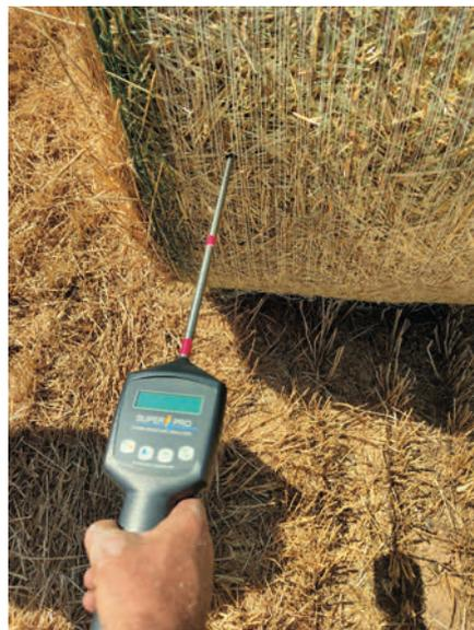
Foto 9. Medida de humedad y temperatura en paca.
