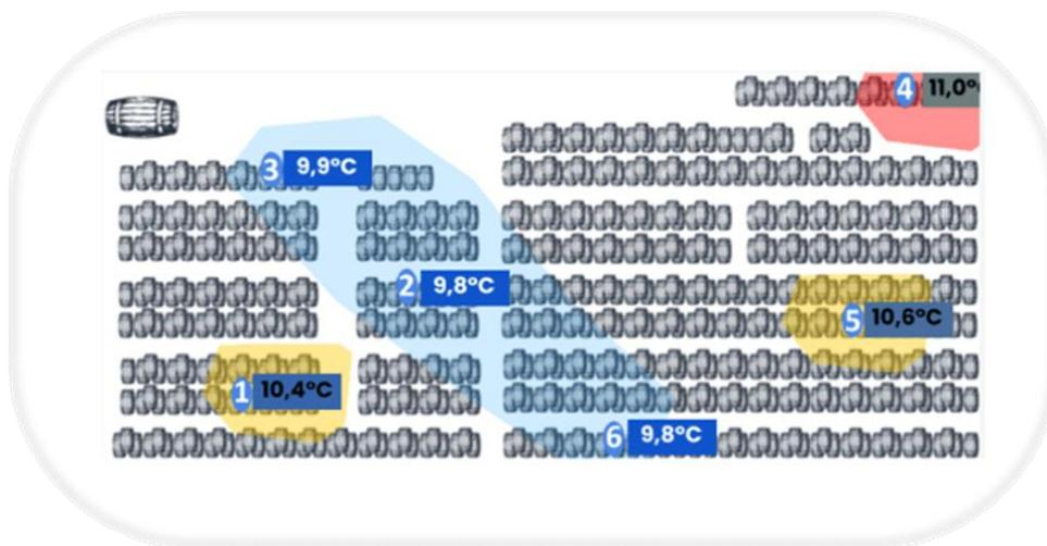
Figura 3. Uso de mapeo de bodegas para identificar microclimas con el fin de optimizar la pérdida por evaporación y ahorrar energía<sup>17</sup>
