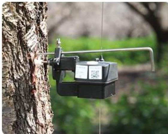
Figura 14. [Dendrómetro](#)
