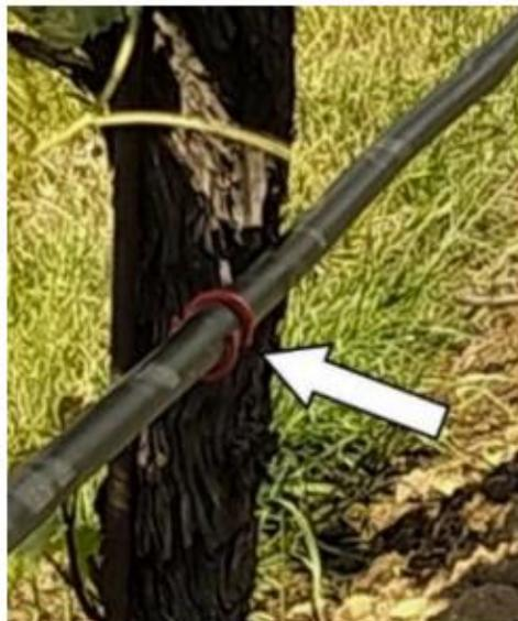
Figura 7. Pinzas de riego aplicadas a los goteros para cerrarlos y modular la distancia, y obtener un sistema de goteo de caudal variable: [grupo operativo VIRECLI](#)
