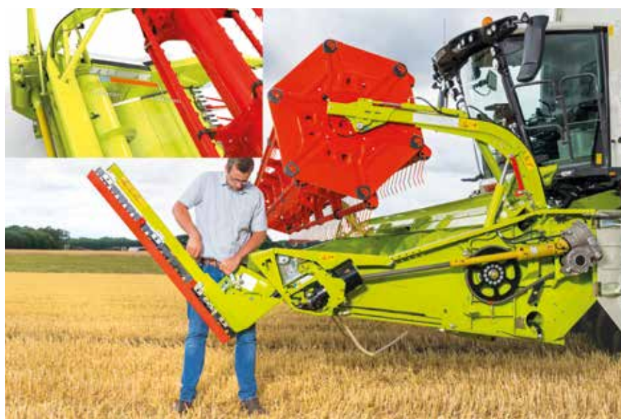
Foto 1. Mecanismo de corte Vario de Claas mediante montaje de barras laterales para colza. El accionamiento de la barra de corte se hace con un eje telescópico. El alargamiento de la plataforma llega a los 60 cm.
