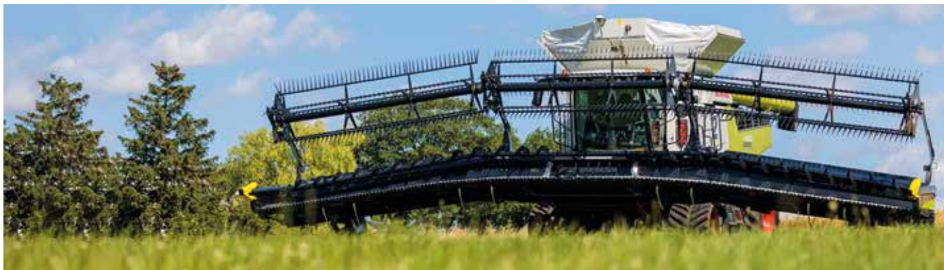
Foto 2. Cabezal XFR (XtremeFlex Razor) de Geringhoff de 15,24 m. Dividido en tres secciones, el ángulo entre ellas puede ser de \pm 7^\circ .
