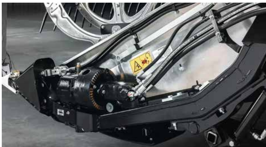
Foto 6. Accionamiento hidráulico de la barra de corte en un cabezal MacDon de la serie FD2.
