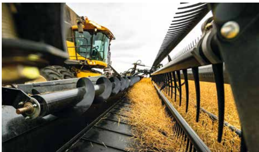
Foto 7. Cabezal tipo draper Airflex NXT de HoneyBee. En colza es interesante el montaje de un pequeño sinfín superior para embocar la mies.
