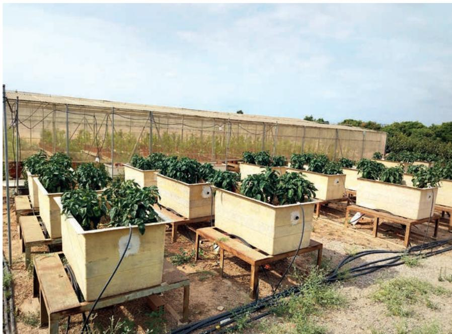
Foto 1. Contenedores del ensayo con sistema de recogida de agua de drenaje con el cultivo de pimiento.
