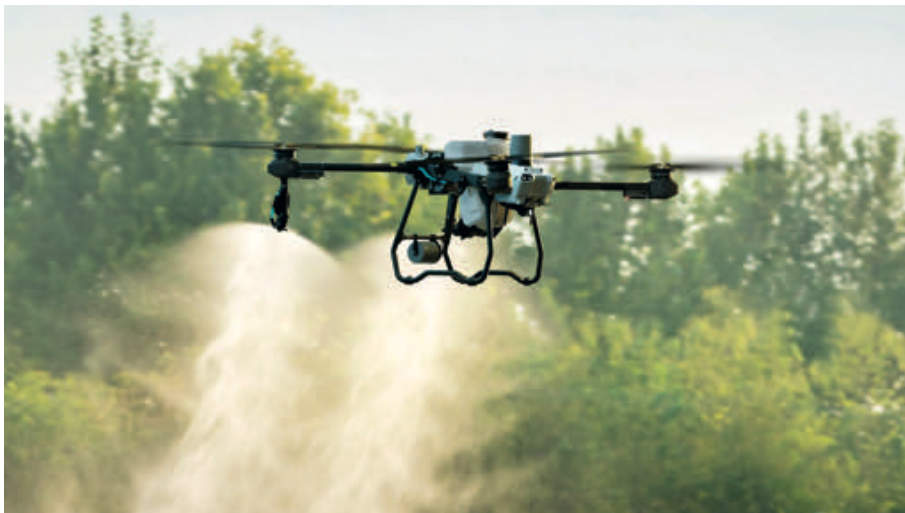
Foto 3. Dron DJI Agras T25 equipado de serie con cabezales centrífugos a velocidad de rotación regulable (Fuente: DJI).
