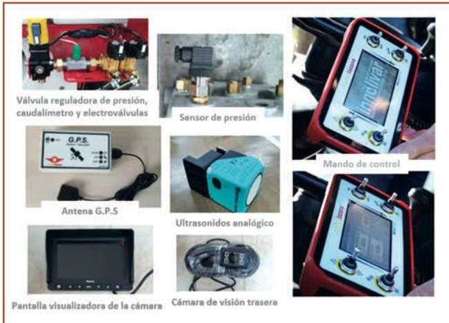
FIGURA 3. Plataforma de gestión de datos y seguimiento del equipo (Prototipo P-A).
