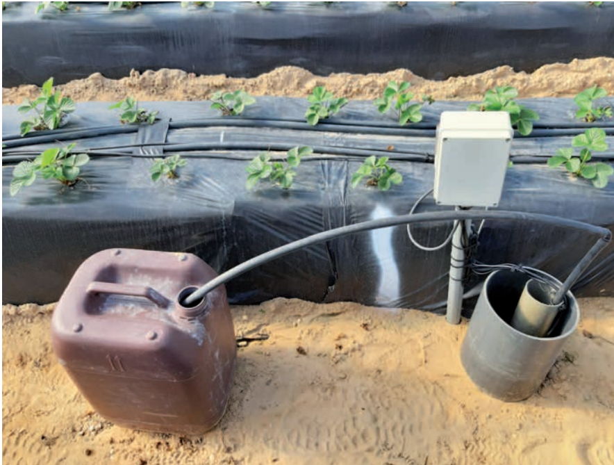
Automatización de la medida de volúmenes de drenaje de los lisímetros.
