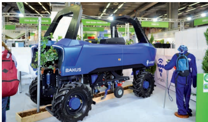
VitiBot ha desarrollado un robot equipado con arados intercepas para el control mecánico de malas hierbas.
