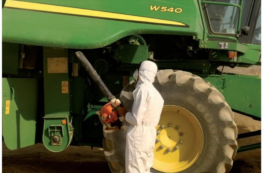
Foto 4. Limpieza de cosechadora mediante soplado.
