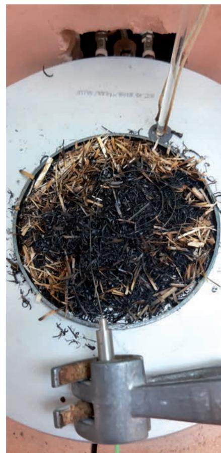
**Foto 1.** Ensayo de laboratorio para determinar la temperatura de ignición del residuo.
