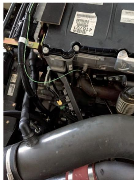
**Foto 2.** Termopar para medir temperatura en salida de gases de escape del motor de una cosechadora.
