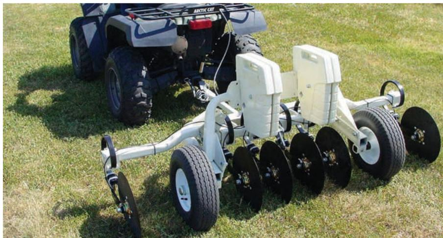
**Foto 1. Ejemplo de dispositivo de mapeado de suelo. En este modelo Veris Quad 2800 se determina la conductividad eléctrica del suelo a dos profundidades.**
