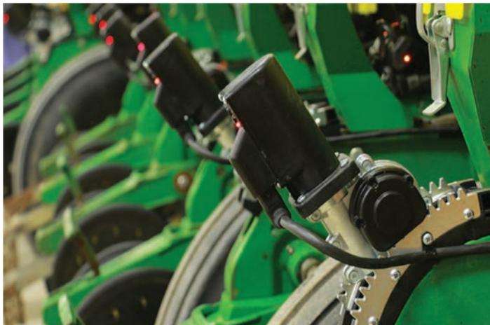
**Foto 5.** SmartDepth de Precision Planting, un motor eléctrico para el control de la profundidad de acuerdo a la información de SmartFirmer.
