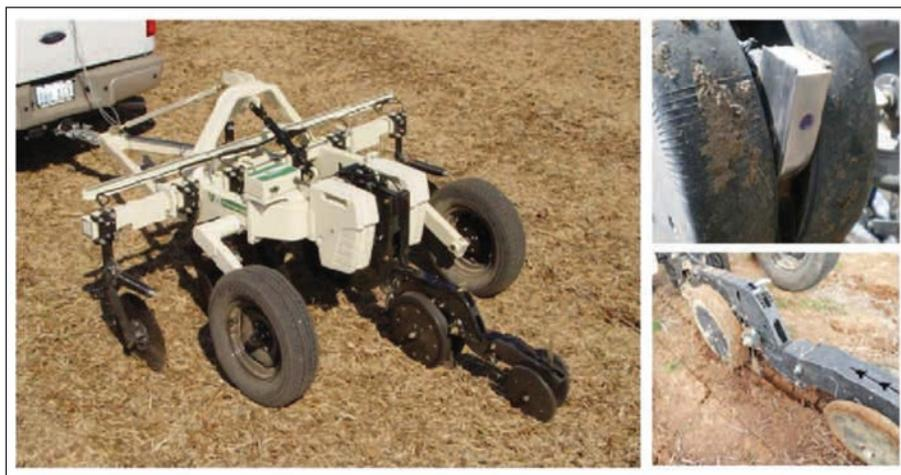
**Foto 4.** Veris Opticmapper que dispone sólo de dos longitudes de onda para determinar a materia orgánica. La patente de 2012 propone un espectrómetro VIS-NIR que actualmente no se comercializa.
