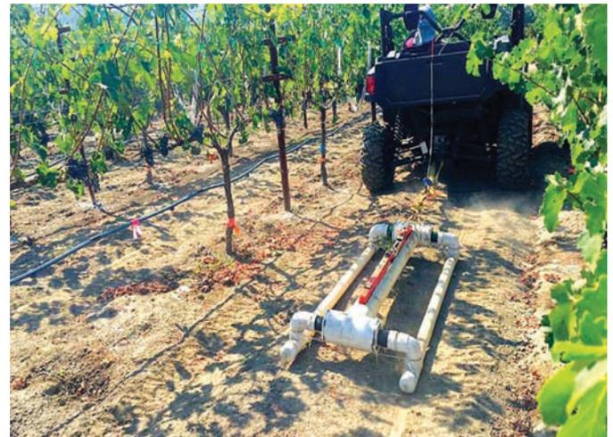
**Foto 3.** Geonics EM38 empleado para determinar la conductividad eléctrica del suelo. Abarca una o dos profundidades dependiendo de si es dual o no.
