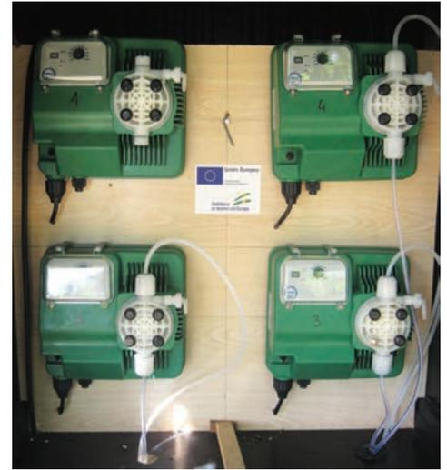
Bombas inyectoras dosificadoras de fertilizantes aplicados en fertirrigación.
