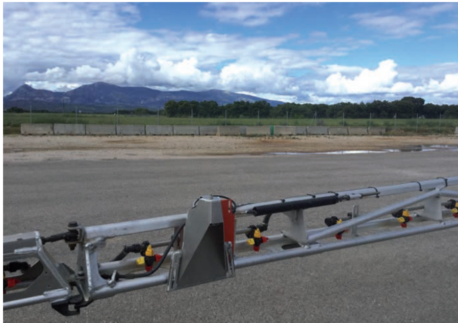
Foto 4. Sensor de ultrasonido para control de altura de barra. Las boquillas están protegidas en el interior de la barra.
