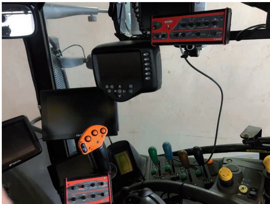
Foto 9. Paneles de control Isoclick (parte inferior) para control de la pulverización y CH10 (parte superior derecha) para el control de plegado/desplegado de la barra.
