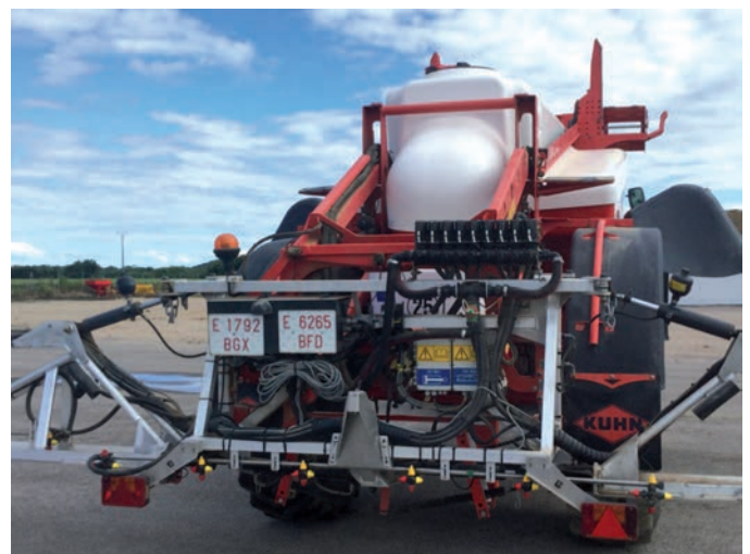
Foto 6. Sistema de suspensión de la barra de pulverización.
