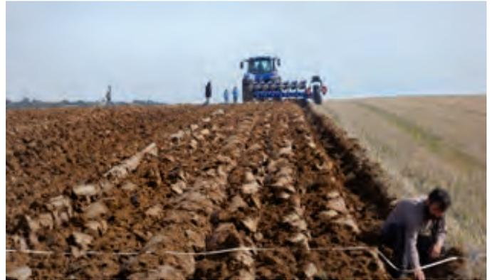
Foto 3. Medición de los anchos útiles de trabajo determinando la anchura real a 25 y 75 m de la besana.
