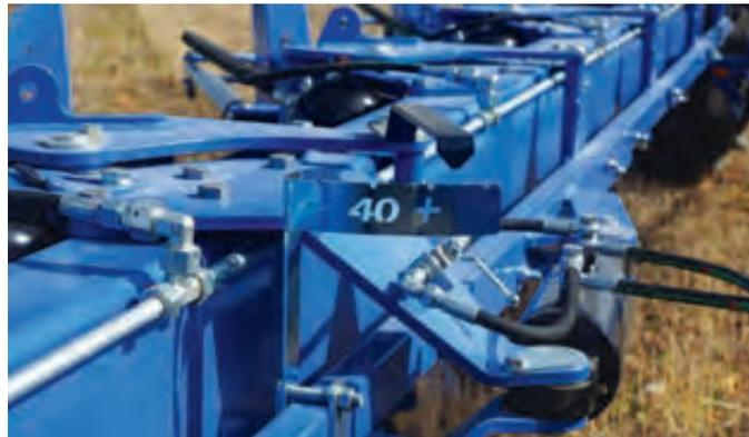
Foto 2. Detalle del ancho de trabajo que se ajusta hidráulicamente entre 30 y 55 cm.
