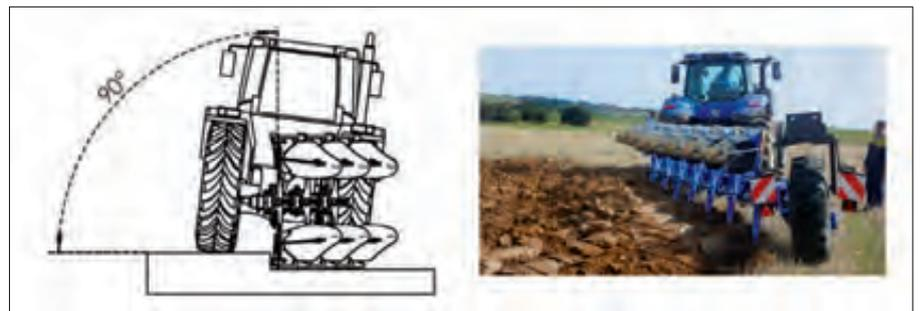
**FIGURA 13.** Ajuste horizontal o longitudinal (evita el talonado de la vertedera).
