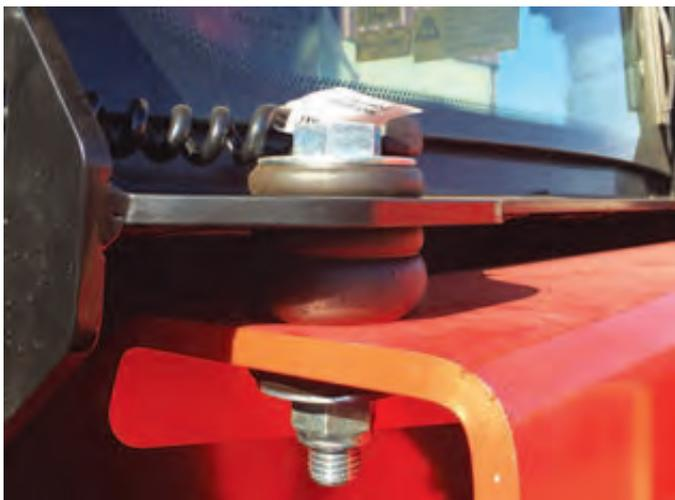
Foto 7. Silent block de apoyo y amortiguación de la cabina en el bastidor de la máquina.
