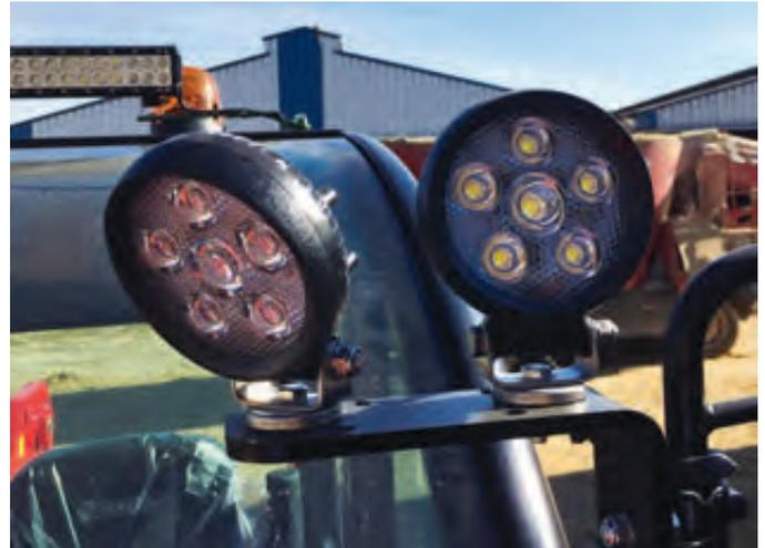
Foto 15. La manipuladora telescópica Faresin 7.35 GLS cuenta con un paquete de luces led exterior para trabajos nocturnos o en naves ganaderas poco iluminadas.
