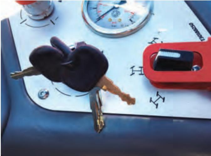
Foto 9. Selector para el modo de funcionamiento de la dirección, con bloqueo mecánico de seguridad para la posición de eje delantero direccional en transporte por carretera.
