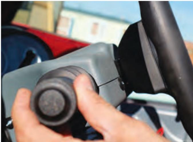
Foto 5. Maneta del inversor a la izquierda del volante. Girando su extremo accionamos las dos marchas bajo carga.
