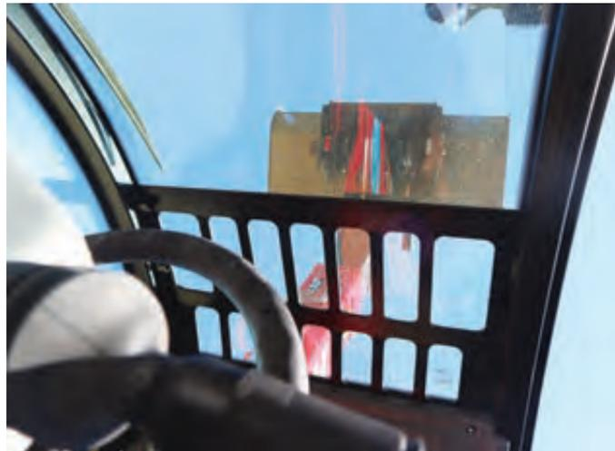
Foto 6. Visión de la protección frente a caída de objetos desde la cabina. Vemos cómo las barras de protección están en sentido longitudinal.
