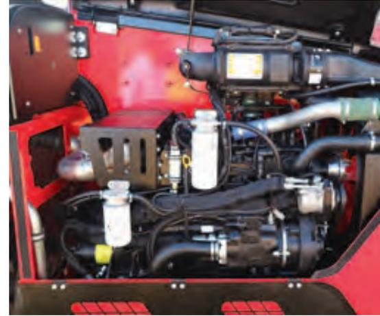
Foto 1. Vista del motor Deutz de la manipuladora telescópica Faresin 7.35 GLS.
