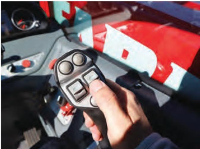
Foto 11. Joystick de control del brazo telescópico de la manipuladora telescópica ensayada.
