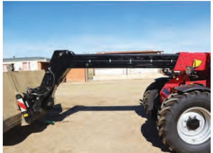
Foto 14. Indicador de la inclinación sobre el brazo telescópico y la zona despliegue, que pueden observarse desde la cabina.
