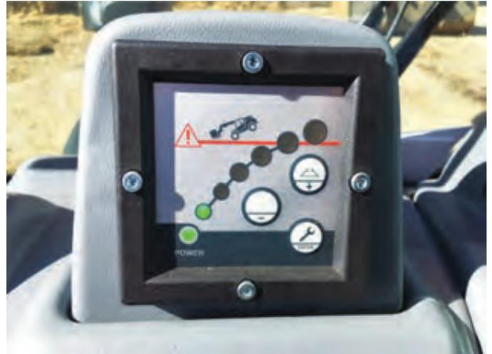
Foto 13. Indicador luminoso que constituye el LLMI (Indicador del Momento de Vuelco Longitudinal), y plano detalle.
