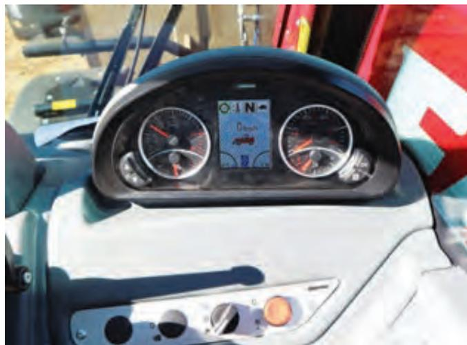
Foto 8. Vista del cuadro de mandos central, con pantalla multifunción central, indicador de revoluciones y temperatura (izda) y velocímetro y nivel de combustible (drcha).
