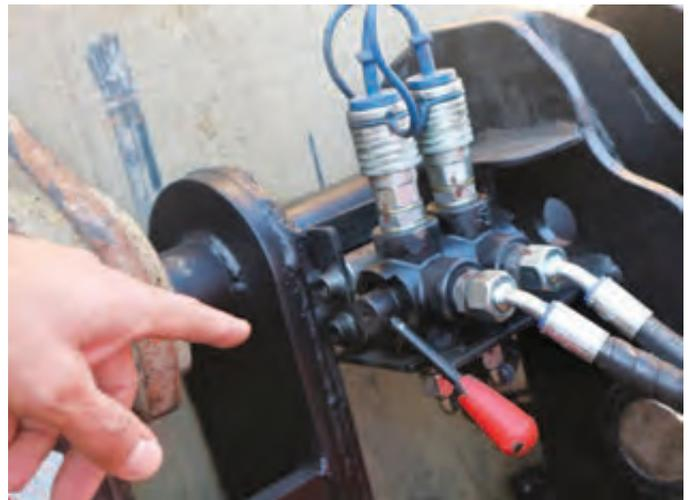
Foto 12. Desviador de caudal ubicado en la parte delantera junto con las dos salidas para suministrar aceite a implementos como horquillas para estiércol o barredoras.
