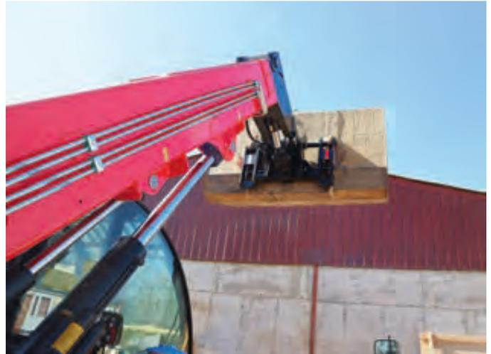
Foto 10. Cilindros de elevación del brazo telescópico de la manipuladora telescópica Faresin 7.35 GLS.
