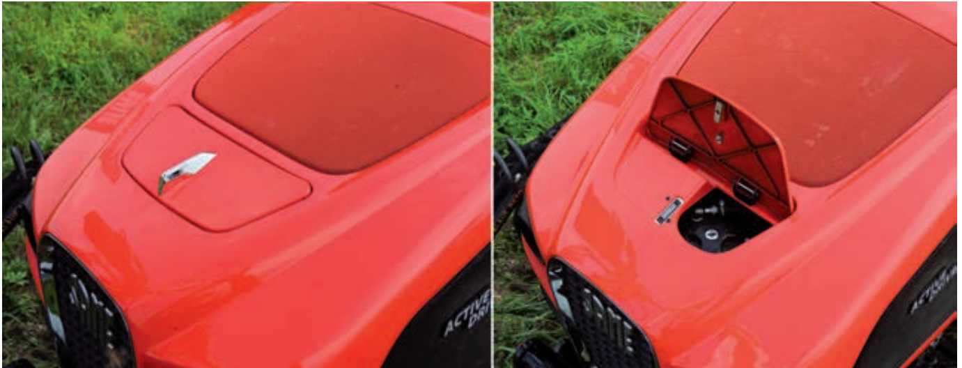
Registro en la parte delantera del capó que, al levantarlo (derecha), deja al descubierto el tapón del depósito de combustible.
