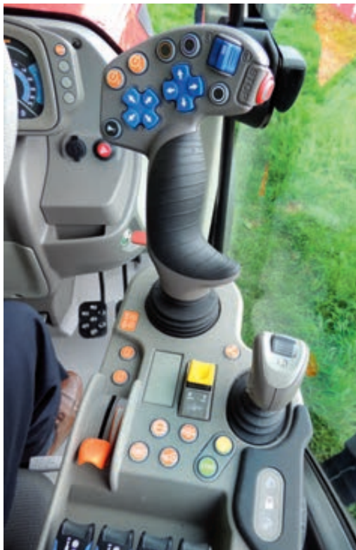
Principales mandos en el reposabrazos a la derecha del conductor. Palanca multifunción y, a su derecha, otra palanca de menor tamaño que comanda algunos distribuidores de servicios externos.
