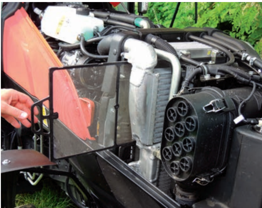
Extracción de la rejilla que evita que la suciedad llegue a los radiadores.
