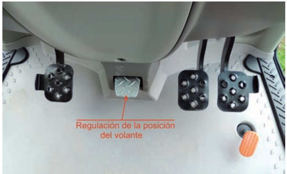
Suelo plano de la cabina donde se encuentra, entre otros, el pedal para regular la posición del volante.
