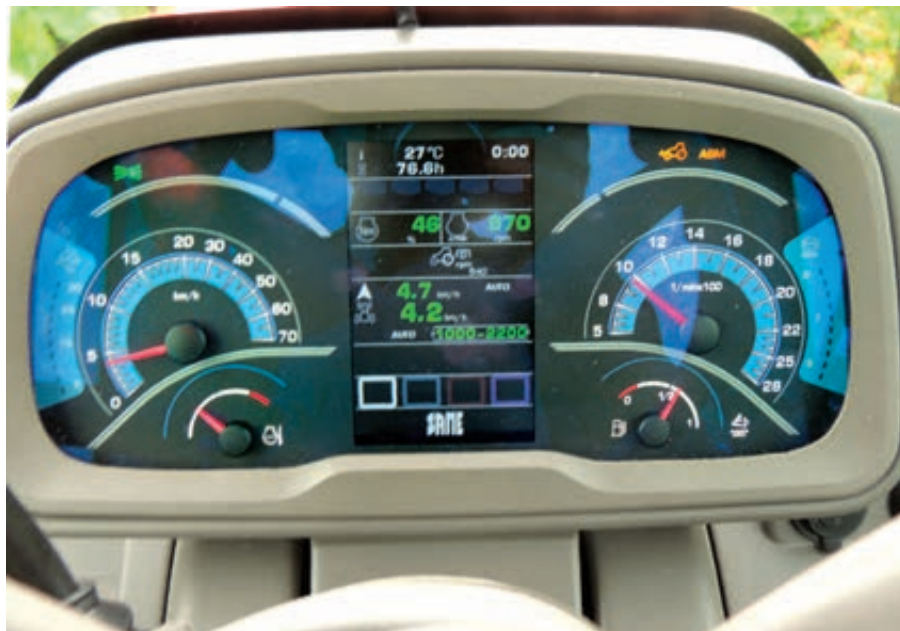
Pantalla en el salpicadero. El tractor está avanzando en el modo Auto; la zona central indica que la velocidad elegida es 4,7 km/h, pero como el pedal del acelerador no está totalmente pisado, la velocidad real de avance es 4,2 km/h.
