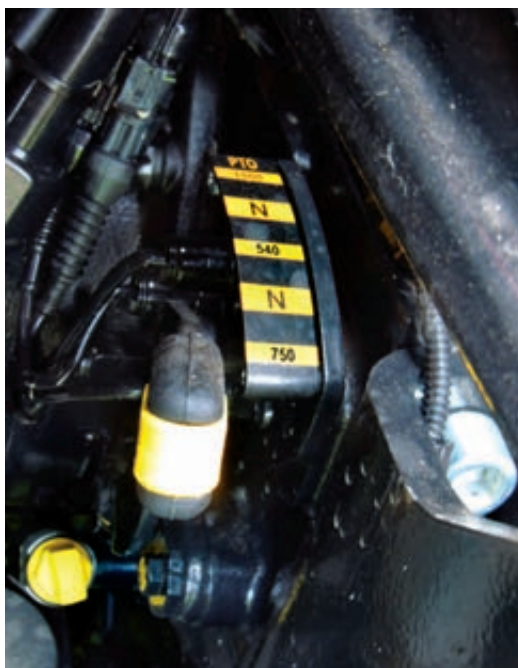
Palanca situada en la trasera del tractor para seleccionar el régimen de la toma de fuerza.
