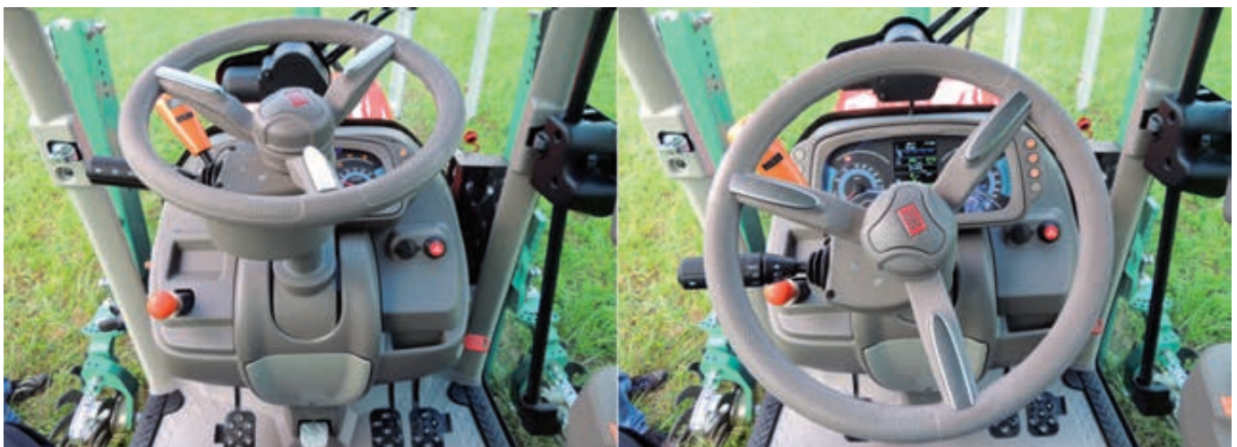
Dos posiciones extremas del volante visto desde la posición del conductor. A la izquierda adelantado y levantado; a la derecha inclinado hacia el conductor.
