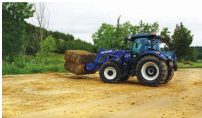
Ensayo de maniobrabilidad con horquilla frontal para evaluar el funcionamiento del sistema Customsteer.
