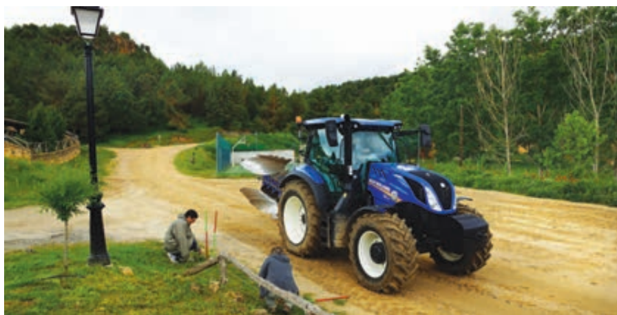
Detalles del ensayo de frenada y registro manual de distancia.
