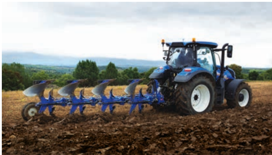
Trabajo con la vertedera New Holland PMV de cuatro cuerpos (ajustada al ancho de trabajo máximo posible).
