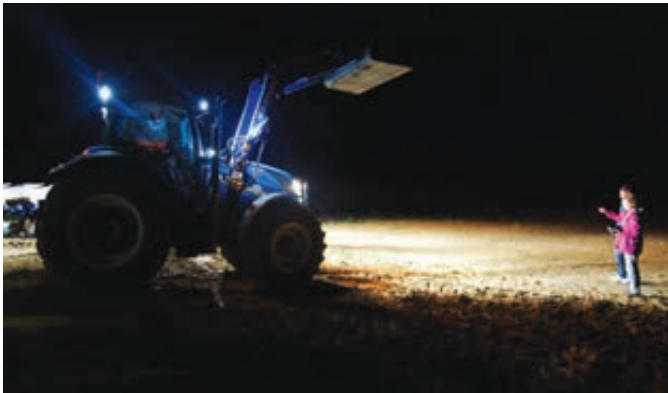
Ensayo de iluminación LED con pala frontal.
