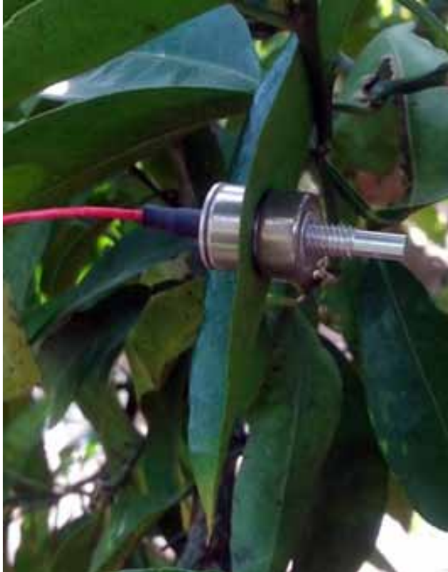
Figura 3. Sonda Zim instalada en una hoja de clementino para la medida en continuo de la turgencia de la hoja
