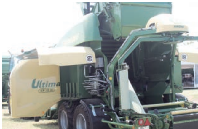
Ultima CF 155 CX es la primera rotoempacadora de cámara semi-variable del mercado que se presentó con sistema non-stop.
