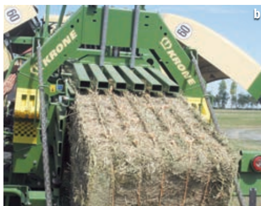
Empacadora BigPack 870 HDP XC Multi-bale (a). Con el sistema Multi-bale, se pueden realizar hasta nueve pacas pequeñas de una paca grande (b).
