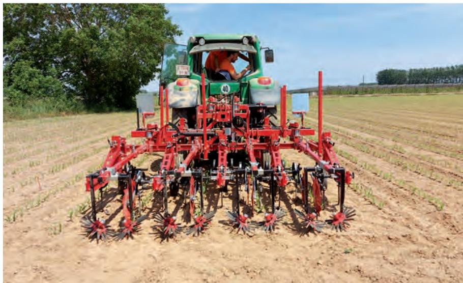
Binadora de precisión equipada con una cámara y ruedas de dedos flexibles (*fingers*).
