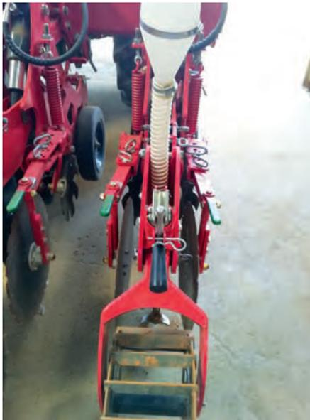
Izquierda, vista desde atrás del rodillo de asentamiento y de los pasadores y las palancas, con empuñadura verde, para el ajuste de la posición de los discos delimitadores. Derecha, punta de la reja descompactadora.
