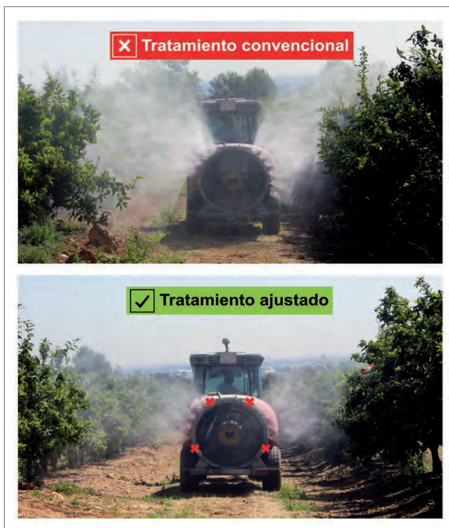
Foto 2. Turboatomizador realizando una aplicación sin ajustar la nube de pulverización a la vegetación (arriba) y ajustando la nube de pulverización a la vegetación (abajo).
