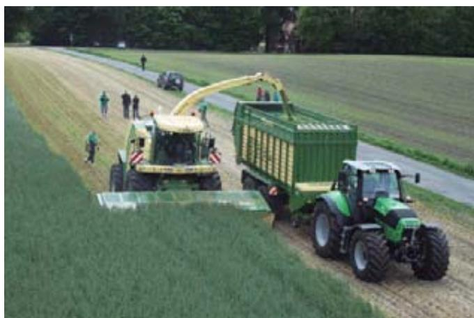
Fotos 7 a 10. Cosechadoras autopropulsadas que disponen de sensores para medir la humedad en el tubo de descarga.
