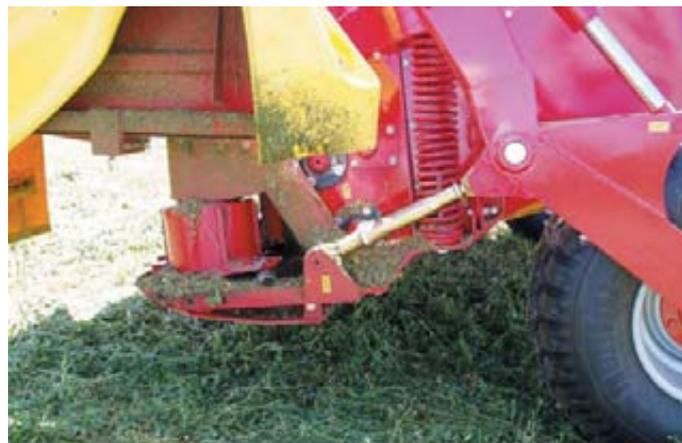
Foto 12. Segadora de discos equipada con acondicionador de rodillos de caucho acanalados. Foto 13. Sistema de regulación de la altura de corte.
